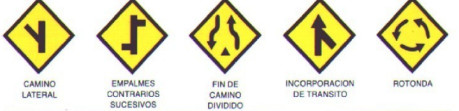
CAMINO LATERAL EMPALMES CONTRARIOS SUCESIVOS FIN DE CAMINO DIVIDIDO INCORPORACION DE TRANSITO ROTONDA
