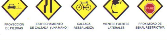
PROYECCION DE PIEDRAS ESTRECHAMIENTO DE CALZADA (UNA MANO) CALZADA RESBALADIZA VIENTOS FUERTES LATERALES PROXIMIDAD DE SEÑAL RESTRICTIVA
