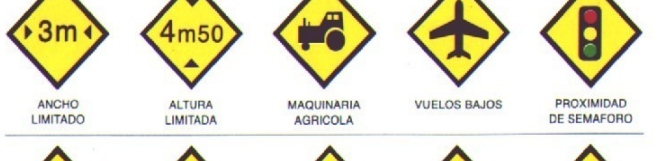
ANCHO LIMITADO ALTURA LIMITADA MAQUINARIA AGRICOLA VUELOS BAJOS PROXIMIDAD DE SEMAFORO
