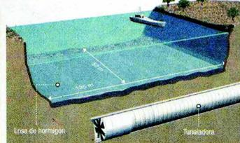
4 La fase siguiente consiste en hormigonar la bóveda y seguir excavando hacia abajo para poder meter máquinas excavadoras por debajo de la bóveda.
