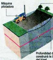
3 Tras finalizar las dos pantallas de pilotes se comienza a excavar entre ellas, hasta llegar a la bóveda del túnel.
