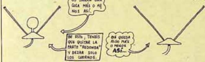
PUES BIEN: EL HILLO DE ESTA ANTENA, LO UNICAREIS: UNO DE LOS POLOS AL TERMINAL ANTENA y EL OTRO POLO AL TERMINAL MASA ó BIEN NEGATIVO (-) SI NO TIENE MASA ESPECIFICADA.
